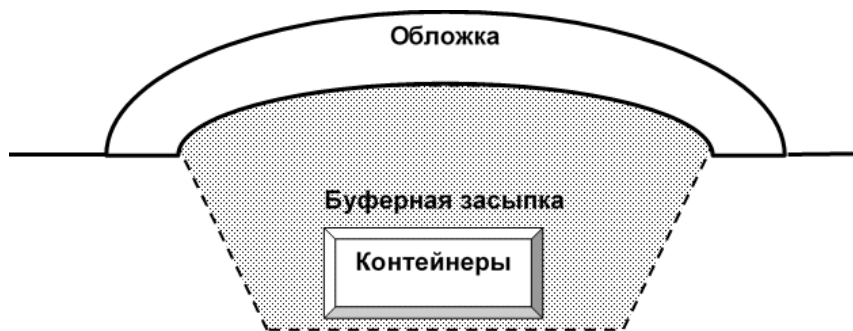
Рисунок 2.10. Структура буферной засыпки (по Performance..., 2001)
